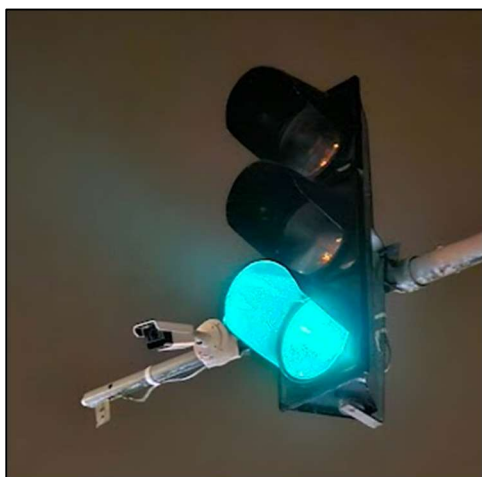
Obr.6: SSZ 5.811 Smíchovská – přechod u Řeporyjského náměstí, kamera s interní videoanalytickou jednotkou
